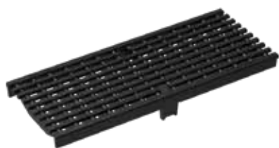
Pitkittäistankoristikko, Pallografiittivalurautainen GJS, Kataporeettinen uppopinnoitus. Kuormitusluokat: D400*, E600* P=50 cm, MW 25 x 11 mm.
