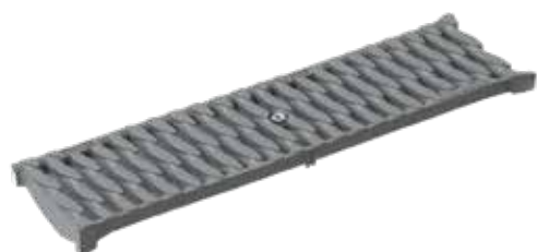
Ritilä, OvalGrip Design, komposiitti, harmaa Kuormitusluokat: B125 , P=50 cm, SW 8 mm.
