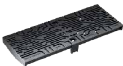
Design-ritilä, WIRE, Valurauta GJS, KTL-käsitelty Kuormitusluokat: D400* P=50 cm, SW 5 mm.
