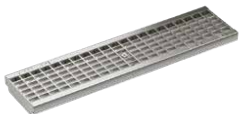
Verkkoritilä, galvanoitu teräs, RST. Kuormitusluokat: B125, C250, D400 P=50 cm, 100 cm. MW 30 x 14 mm / 30 x 10 mm / 20 x 14 mm
