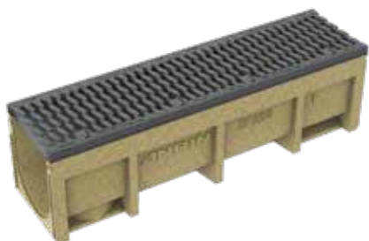
SF-200-kouru, jossa raollinen pallografiitti-valurautaritiä, kuormitusluokka F900
