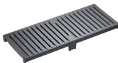
Ritilä, HEELGUARD, Valurauta GJS, lakattu musta. Kuormitusluokat: D400* P=50 cm, SW 6 mm.
