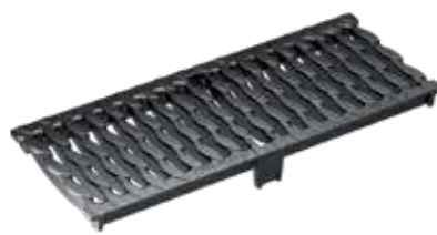
OvalGrip-muotoiltu uritettu ritilä, Valurauta GJS, KTL-käsitelty Kuormitusluokat: D400*, E600* P=50 cm, SW 12 mm.
