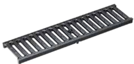
Ritilä SW 10, valurauta, KTL-käsitelty Kuormitusluokat: C250 , P=50 cm, SW 10 mm.
