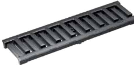
Ritilä, MASSIV 32, Valurauta, KTL-käsitelty Kuormitusluokat: P=50 cm, SW 11 mm Sopii vain KE-100:lle.
