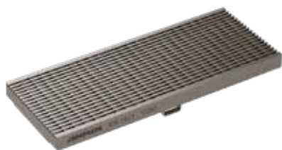
Pitkittäisprofiiliristikko, RST Kuormitusluokat: C250 P=50 cm, 100 cm, SW 5 mm.
