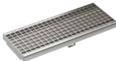
Verkkosäleikkö, sinkitty, RST. Kuormitusluokat: C250, D400* P=50 cm, 100 cm, 20 x 20 mm.
