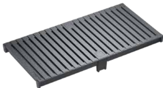
Ritilä, HEELGUARD, Valurauta GJS, musta pinnoite, Kuormitusluokat: D400* , P=50 cm, SW 6 mm.
