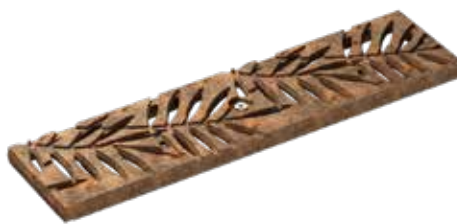
Design-ritilä, LEAF, Valurauta, käsittelemätön. Kuormitusluokat: C250 , P=50 cm, SW 5 - 9 mm.
