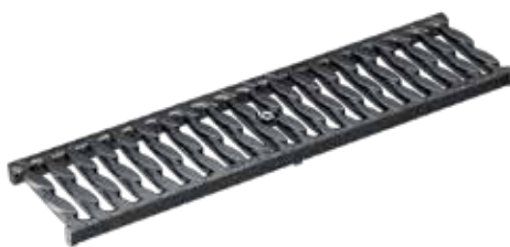
Ritilä, OvalGrip Design, valurauta, KTL-käsitelty Kuormitusluokat: C250, E600, F900* , P=50 cm, SW 10 mm. * Vain KF-100:lle
