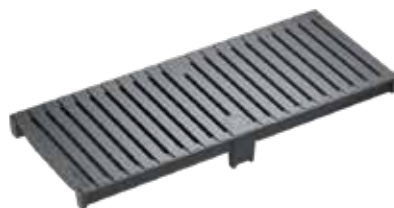
Ritilä, HEELGUARD, Valurauta GJS, lakattu musta. Kuormitusluokat: D400* P=50 cm, SW 6 mm.
