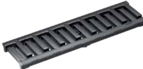
Ritilä, MASSIV 32, Valurauta, KTL-käsitelty Kuormitusluokat: P=50 cm, SW 11 mm Sopii vain KE-100:lle.
