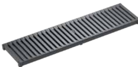
Ritilä, HEELGUARD, Valurauta, lakattu musta. Kuormitusluokat: D400* , P=50 cm, SW 6 mm.
