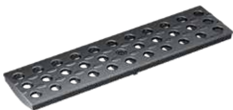
Design-ritilä, CIRCLE, Valurauta, KTL-käsitelty Kuormitusluokat: D400 , P=50 cm, Ø 19,5 mm.
