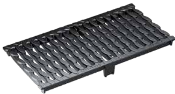
OvalGrip muotoiltu uritettu ritilä, Valurauta GJS, kataporeettinen uppopinnoite Kuormitusluokat: , P=50 cm, SW 12 mm. Kuormitusluokat: D400*, E600*
