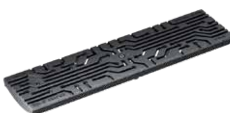
Ritilä, WIRE Design, Valurauta, KTL-käsitelty Kuormitusluokat: D400* , P=50 cm, SW 5 mm.
