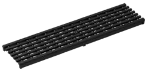
Pitkittäissuuntainen itilä, valurauta, KTL-käsitelty Kuormitusluokat: D400* , P=50 cm, MW 25 x 10 mm.
