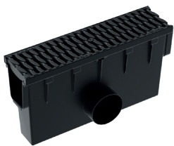
EVO 0150 Kouru- ja öljypohjaysikkö jossa on pallografiittivalurautainen ritilä OvalGrip-ritilä. kuormitusluokka C250
