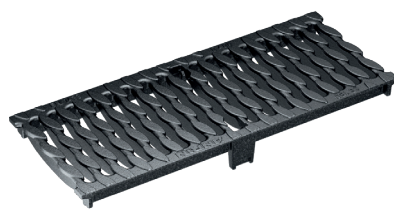
OvalGrip-muotoiltu uritettu ritilä, Valurauta, KTL-käsitelty Kuormitusluokat: D400*, E600* P=50 cm, SW 12 mm.
