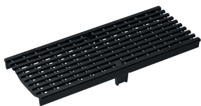
Pitkittäistankoristikko, Pallografiittivalurautainen, Kataporeettinen uppopinnoitus. Kuormitusluokat: D400*, E600* P=50 cm, MW 25 x 11 mm.
