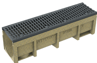
SF-200-kouru, jossa raallinen pallografiitti-valurautaritiä, kuormitusluokka F900
