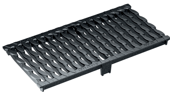
OvalGrip muotoiltu uritettu ritilä, Valurauta, kataporeettinen uppopinnoite Kuormitusluokat: D400/E600* P=50 cm, SW 12 mm.
